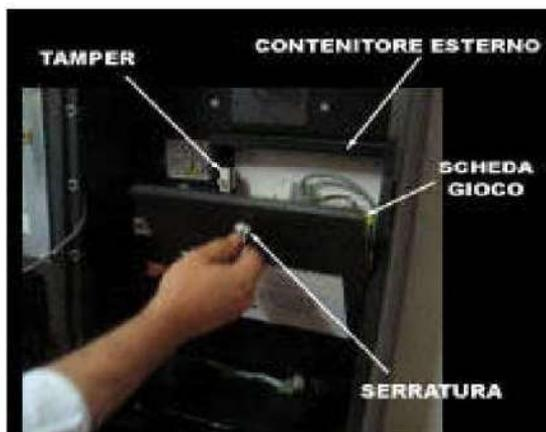
**Foto del contenitore di protezione opzionale per i mobili CRISTALTEC da utilizzare in alternativa al box di serie della scheda gioco.**
